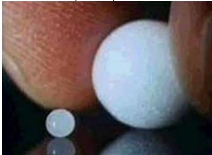
Figura 1 - Pérola de poliestireno antes da expansão e granulado de EPS gerado após a expansão.
